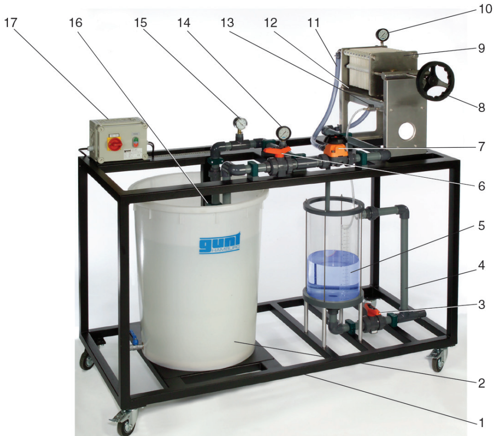
8.1. att. Rāmju filtrspiedes iekārta: (1) iekārtas statīvs; (2) suspensijas tvertne ar izlaišanas krāns; (3) filtrāta tvertnes krāns; (4) filtrāta tvertnes pārplūdes caurule; (5) filtrāta tvertne; (6) cirkulācijas līnijas krāns; (7) membrānas ventilis; (8) vārpstas rats; (9) rāmju filtrspiede; (10) manometrs pie ieplūdes filtrā; (11) filtrāta izplūdes caurule; (12) filtrāta uztveršanas vanna; (13) uztveršanas vannas pārplūdes krāns; (14) manometrs; (15) termometrs; (16) iegremdējamais sūknis; (17) vadības panelis.
