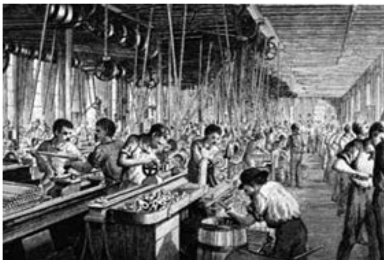
1.1. attēls. Rūpnīcas "McCormic" vārpstu telpa 1885. gadā. Šis uzņēmums ražoja arī slaveno "McCormic" pļaujmašīnu. Pievērsiet uzmanību siksnām, kas katru darba vietu savieno ar kopēju rotējošu vārpstu pie griestiem (avots: Wisconsin Historical Society ).
